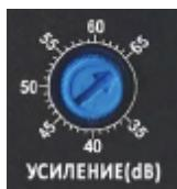
На фото представлен пример ручки РРУ. В зависимости от модификации репитера её внешний вид может немного меняться. В данном случае установлено максимально возможное для этого репитера усиление. Если эту ручку повернуть против часовой стрелки то, можете установить нужное Вам усиление с шагом 1 dB.
